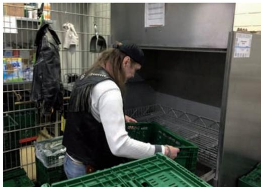
Die Kistenwaschmaschine läuft ca. 6 Stunden am Tag, in denen sage und schreibe 200 Kisten pro Stunde den Reinigungsprozess durchlaufen.
